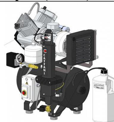
**070269 Двухцилиндровый компрессор без осушителя**, однофазный двигатель, мощность двигателя 0,55кВт, объём ресивера 24 л, мощность компрессора при избыточном давлении 5 бар–160 л/мин.<sup>-1</sup>, уровень шума 70 дБ, габаритные размеры: шир.–540мм, гл.– 530 мм, выс-730 мм. Вес нетто 44 кг
